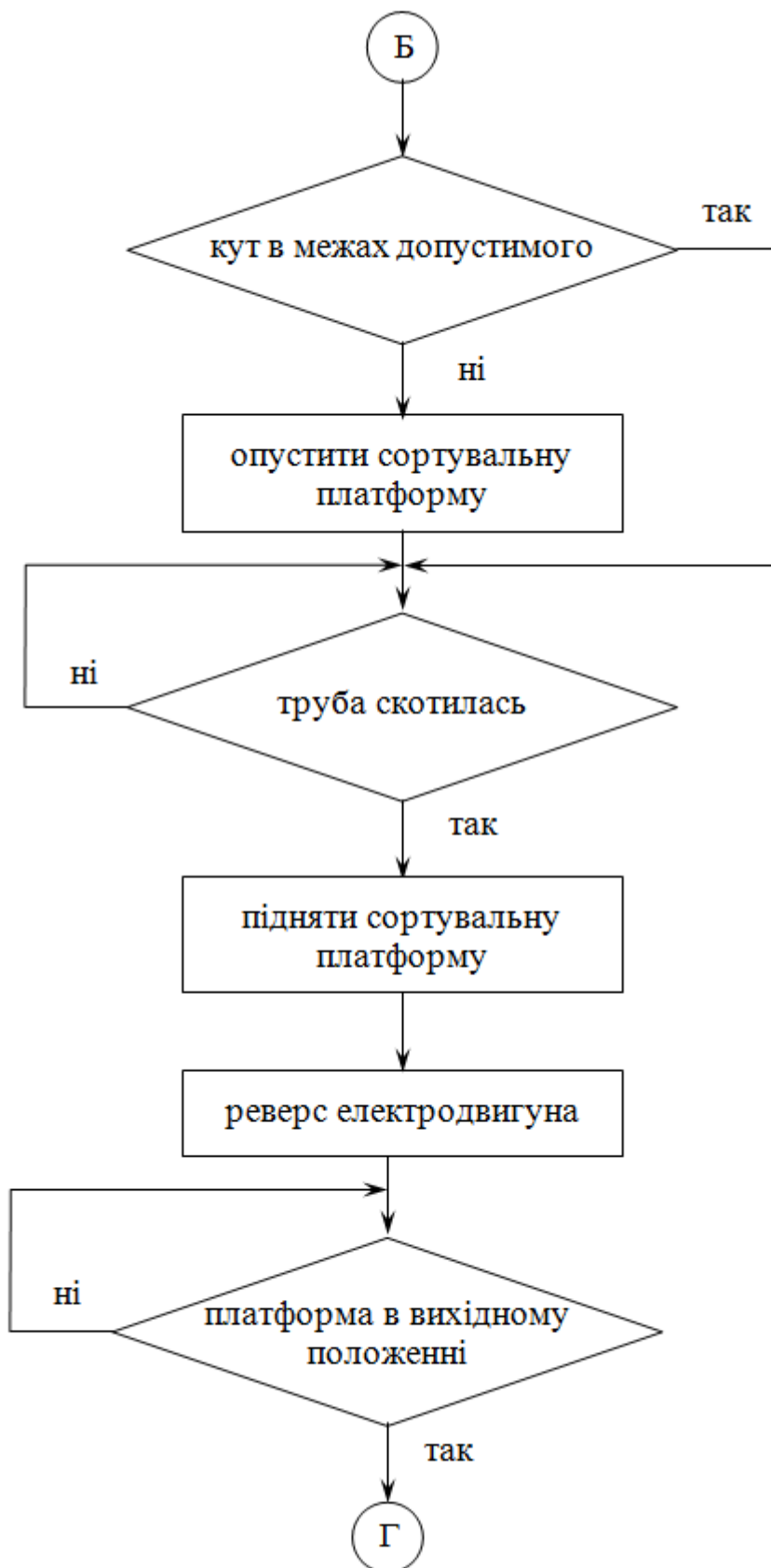
Продовження рисунка 4.2 – Блок-схема алгоритму роботи мікропроцесорної системи
