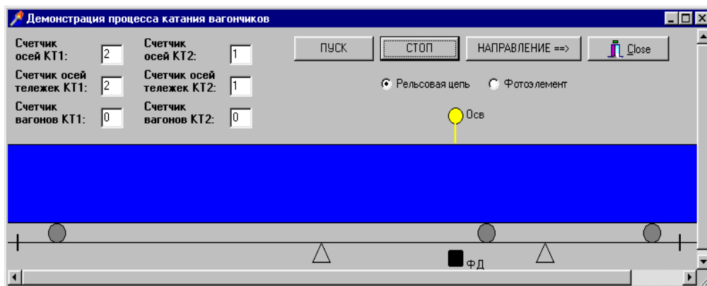
Рис. 2. Демонстрація процесу руху відчепа на контрольній дільниці
