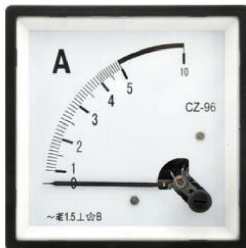
Рисунок 1.5 – Амперметр для змінного струму системи електромагнітної
