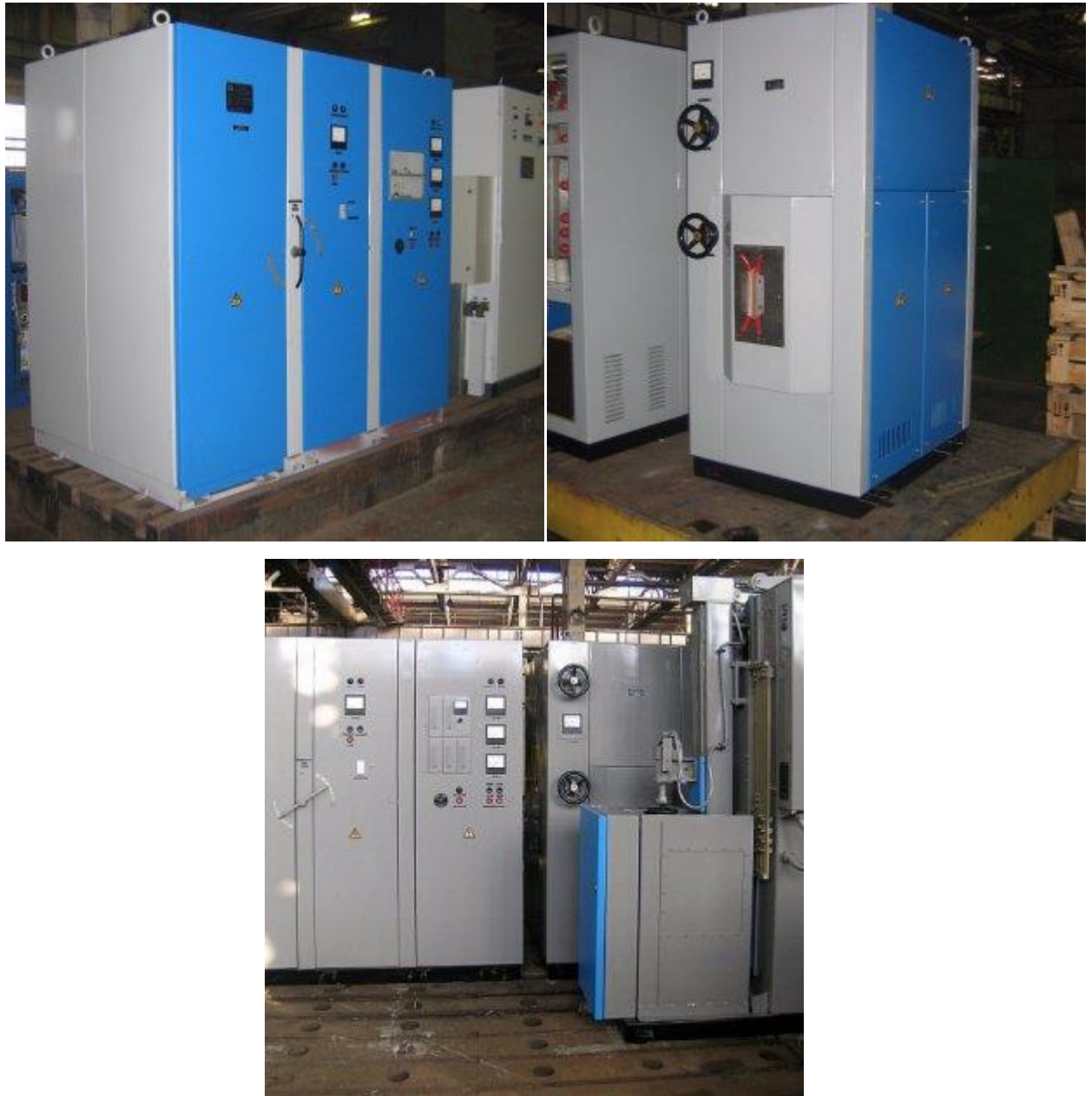
Рисунок 2.2 Загальний вигляд генератора типу ВЧГ3-160/0,066
