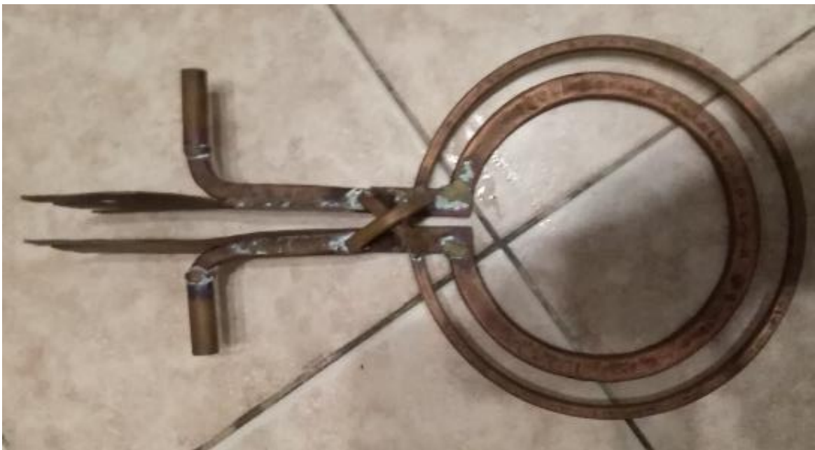
Рисунок 2.3 Загальний вигляд двовиткового кільцевого індуктора
