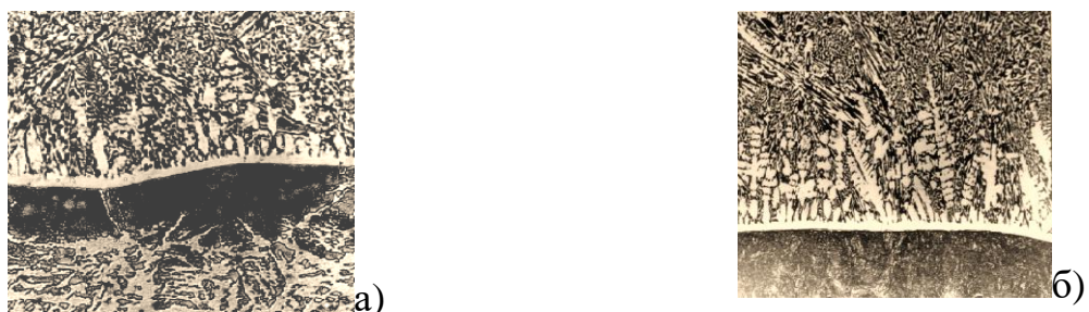
Рис. 3.2. Мікроструктура ( \times 200 , зменш.2/3) наплавленого металу: а – традиційна технологія одночасного наплавлення; б – із застосуванням теплового та електромагнітного екранів
