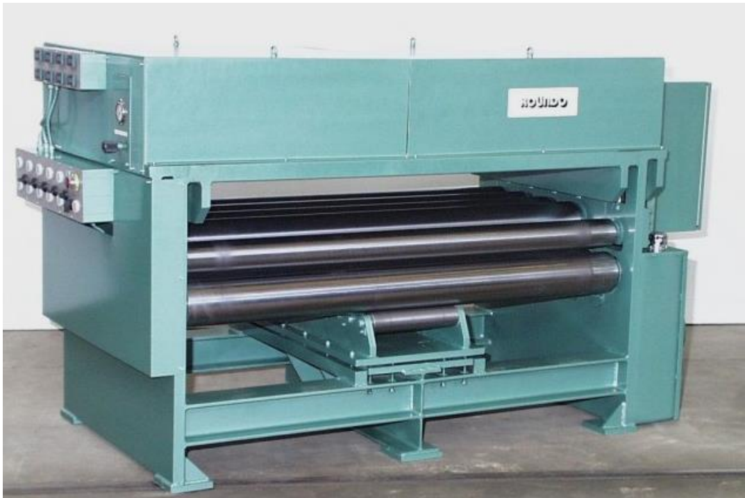
Рис. 2.4 Загальний вигляд листопривильної машини Roundo PRH 120 / 1500
