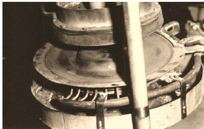
Рис. 1.3. Загальний вигляд неперервно-послідовного індукційного наплавлення [1]
