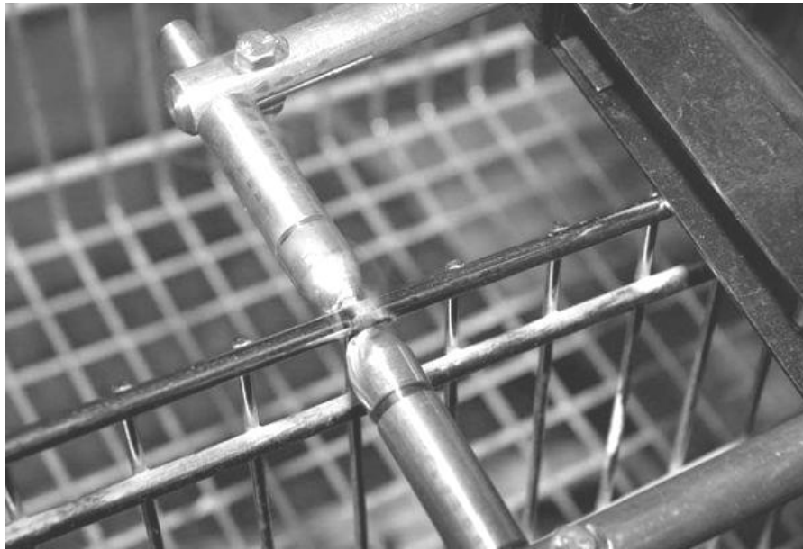
Рис. 1.4 – Контактне зварювання для виготовлення металоконструкцій
