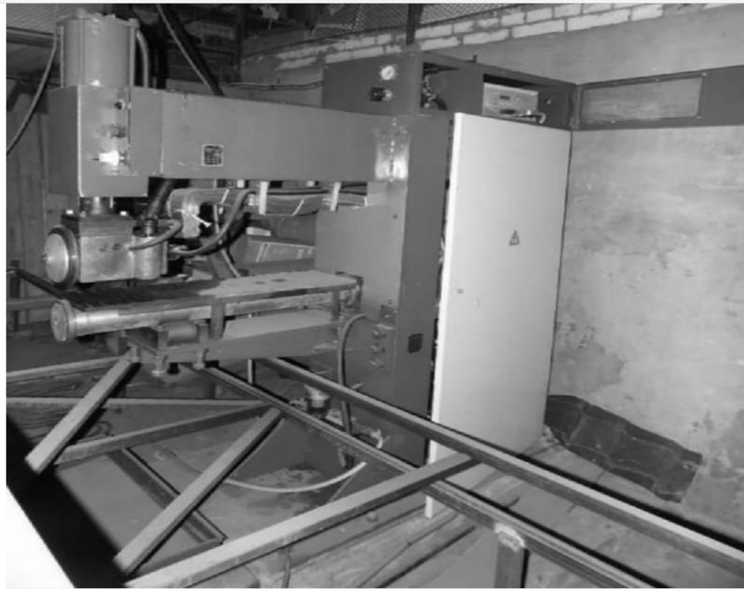
Рисунок 1.6 – Загальний вигляд зварювальної шовної машини МШ-2203
