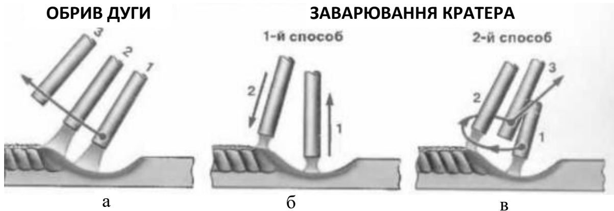
Рисунок 1.5 – Способи закінчення зварювання, або переривання дуги:
