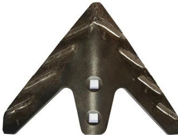
Рис.1.4 Загальний вигляд зміцненої лапи способом електродугового локального зміцнення
