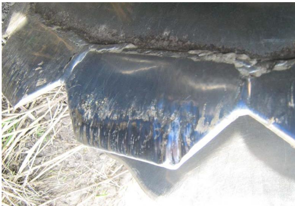
Рис.1.5 Загальний вигляд зміцненого диска способом електроерозійного оброблення [3]
