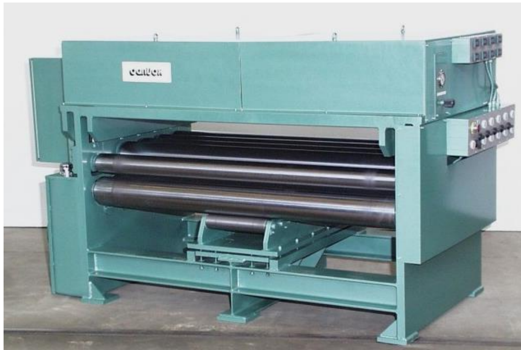
Рис. 2.4 Загальний вигляд листопрямуючої машини Roundo PRH 120 / 1500 [9]
