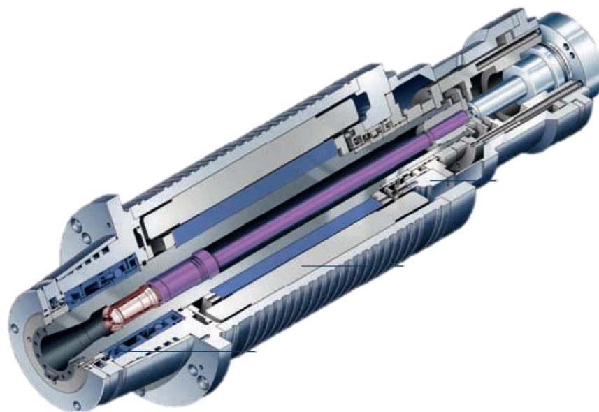
Рисунок 1.6 - Приводи головного руху фрезерних верстатів з ЧПК без коробок швидкостей: а)прямий привод; б, в) приводи із проміжною пасовою; г)
