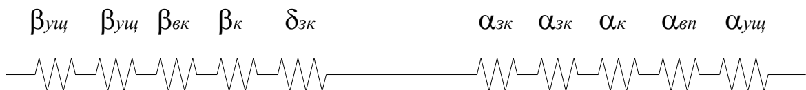
Рис. 3.6. Конструктивна схема при розрахунку осьової жорсткості
