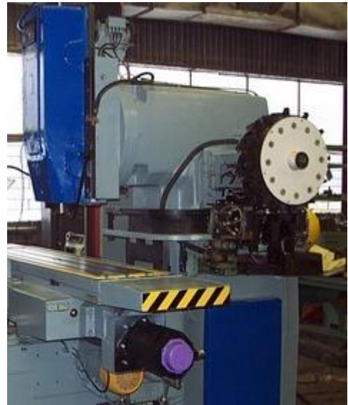
Рисунок 1.11 - Вертикально-фрезерний верстат ГФ2171 з магазином типу «РУКА» і диском з інструментами [15]
