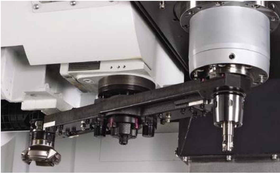
Рисунок 1.13 - Інструментальний магазин типу «Рука» вертикально-фрезерних обробних центрів FEELER серія HV [16]
