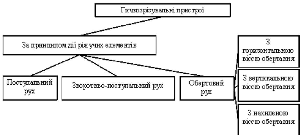
Рисунок 1.5. - Класифікація гичковидаляючих пристроїв за принципом роботи їх ріжучих елементів
