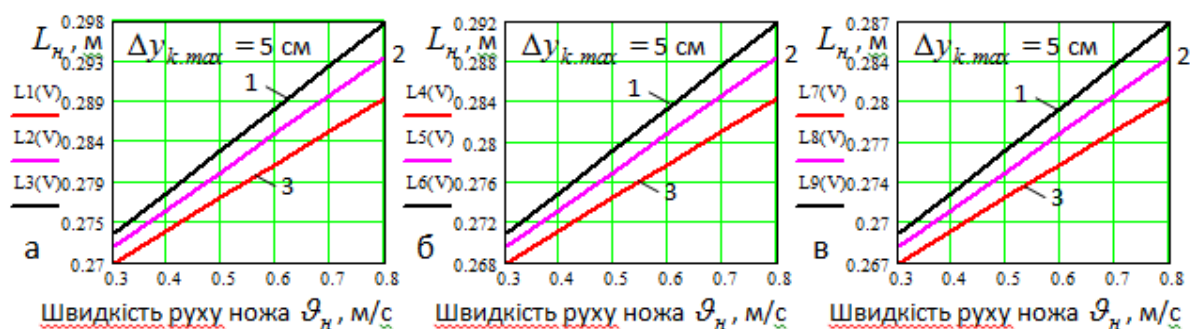
Рисунок 3.4 – L_n = f_L(\varrho_n) : а, б, в – \varrho = 1,6; 1,9; 2,2 м/с; 1, 2, 3 – D_{rk} = 0,1; 0,15; 0,2 м
