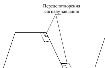
Рис. 4.2 Схема сигналу завдання із введеним передспотворенням
