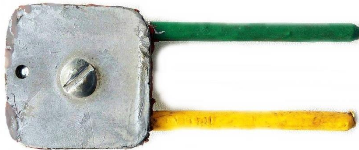
Рисунок 1.10 - Саморобний чутливий елемент, зроблений на основі двох металевих стрижнів з термоусадкою і діелектрика, що фіксує між собою стрижні
