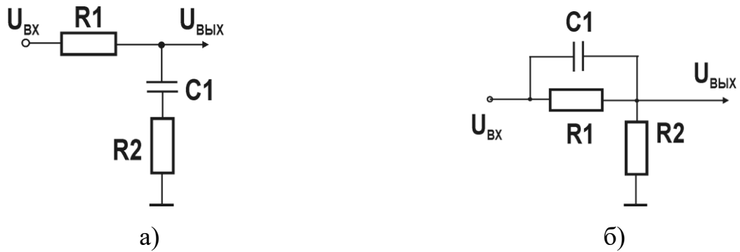
Рисунок 3.11 - Принципові схеми коректуючих пристроїв: а) КУ 1 -інтегруючий; б) КУ 2 -диференціюючий.
