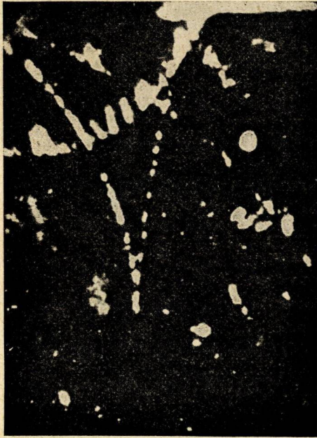
Рис. 4. Сліди пари електронів, додатного та від'ємного, витворених фотоном променів \gamma в коморі Вільсона, уміщеній у магнетнім полі.
