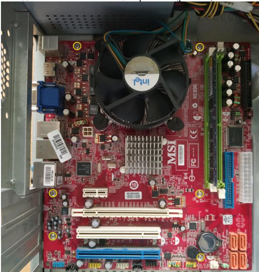
Рис.3.17. Кріплення системної плати на панелі корпусі за допомогою гвинтів
