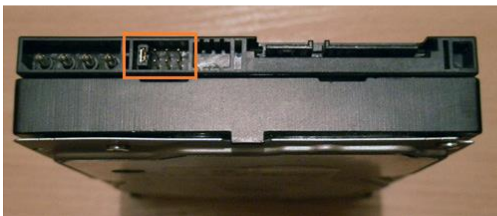
Рис. 7.5. Перемички на накопичувачі Serial ATA
