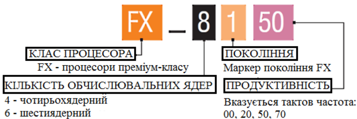
Рис.4.5. Розшифрування маркування процесора AMD FX
