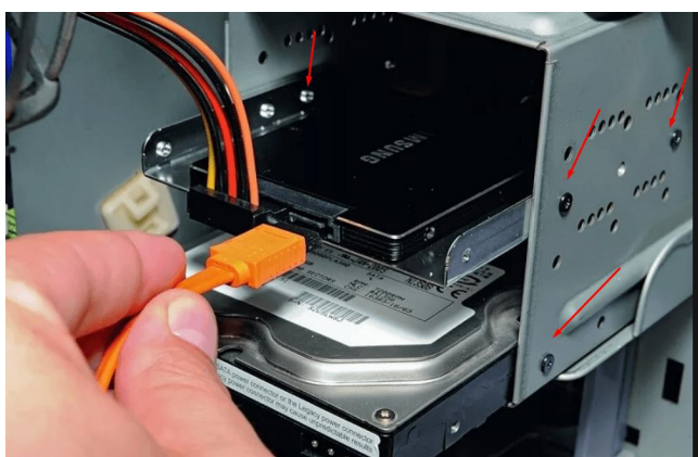
Рис.7.29. Підключення SSD до блоку живлення та материнської плати
