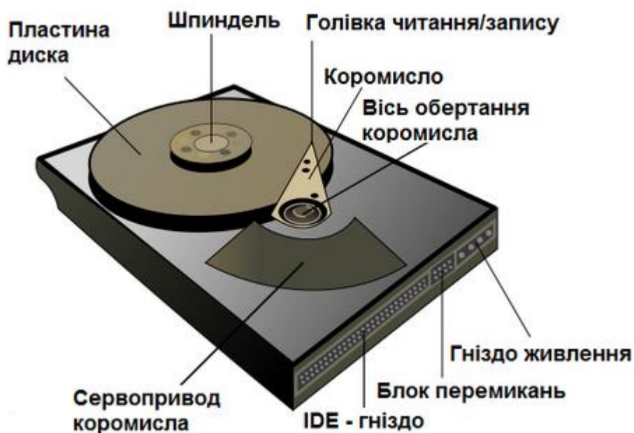
Рис.7.2. Конструкція HDD
