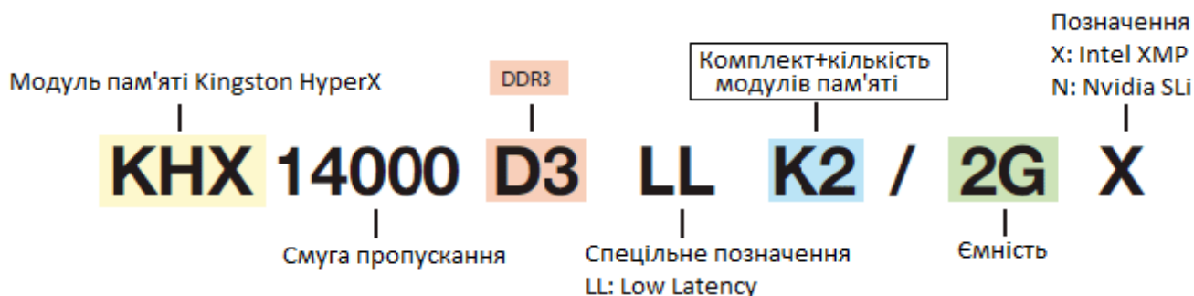
Рис. 6.16. Модуль пам'яті Kingston HyperX типу DDR3 (виробництво, яких припинено осінню 2009 року)
