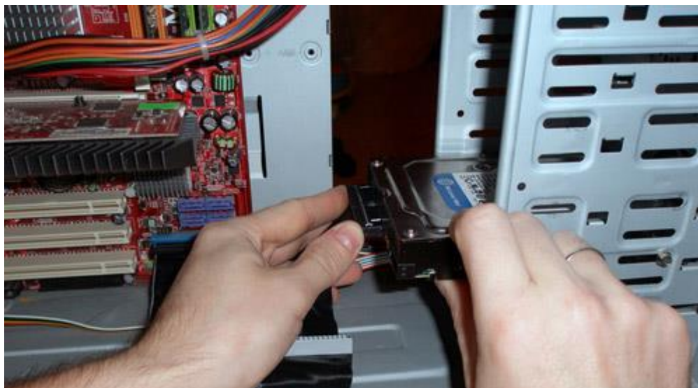
Рис.7.15. Підключення ведучого і веденого жорстких дисків
