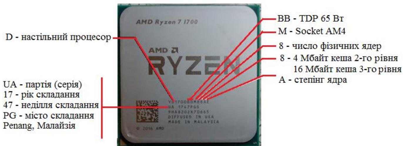
Рис.4.8. Розшифрування маркування процесора AMD Ryzen
