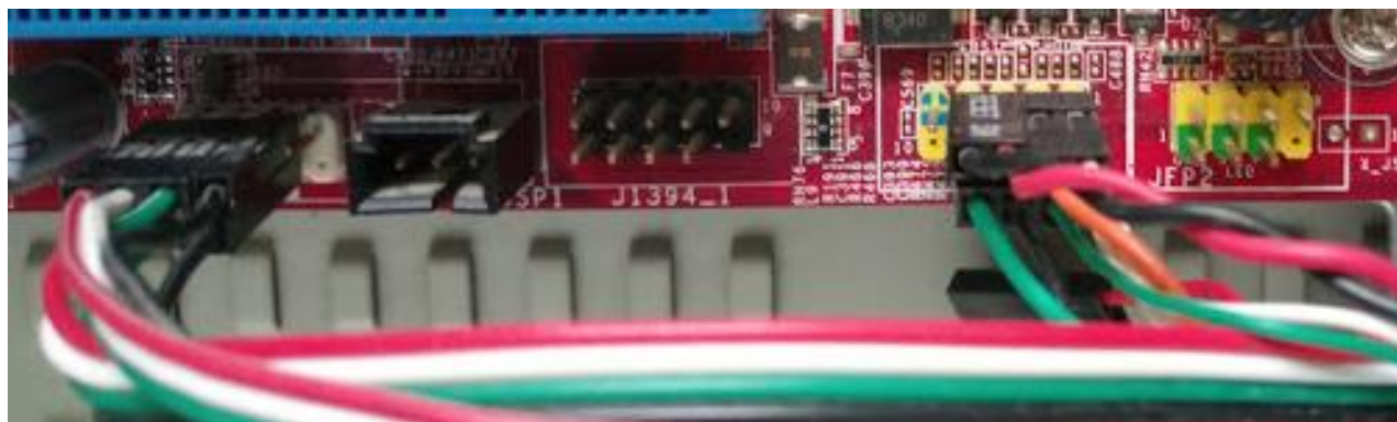
Рис.3.21.Варіант підключення елементів передньої панелі до роз'ємів системної плати
