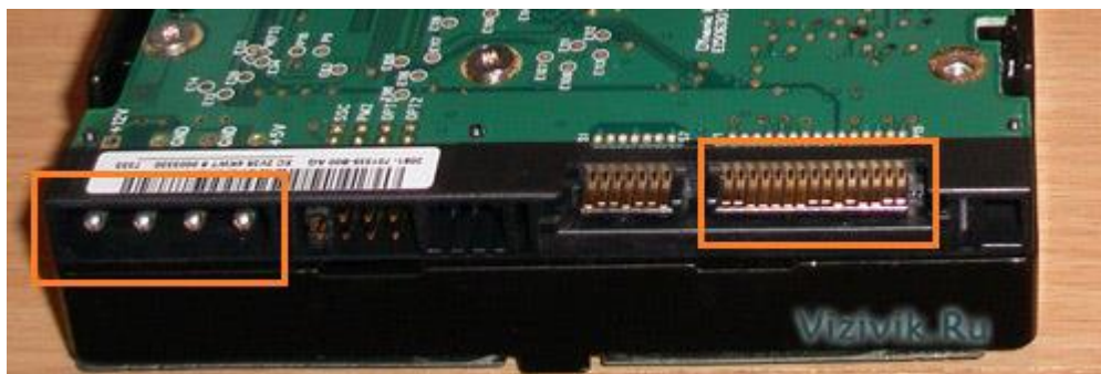
Рис.7.21. Жорсткий диск з 2 гнізда живлення
