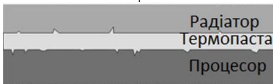
Рис.5.6,а. Некоректне нанесення товщини термопасту
