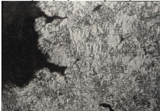
Рис.6. Мікроструктура осадженої міді (поздовжній переріз), \times 120
