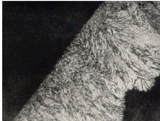
Рис.7. Мікроструктура осадженої (поперечний переріз) міді, \times 120
