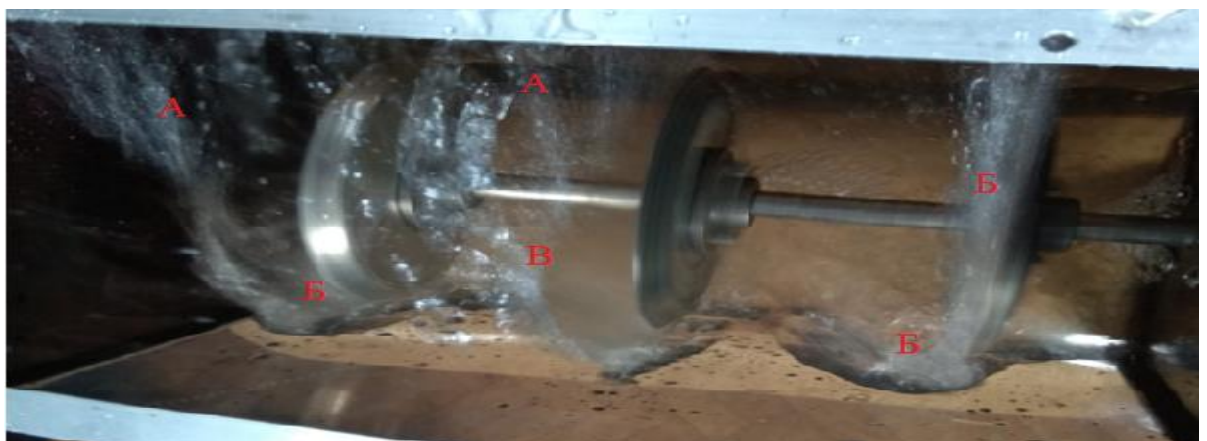
Рис. 3.5. Динаміка руху рідини при обертанні тарільчастого робочого органу
