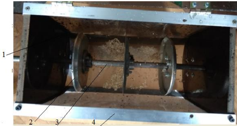
Рис.3.4. Фотографія експериментальної моделі змішувача: 1 – робоча камера; 2 – тарільчасті робочі органи; 3 – привідний вал; 4 – станина
