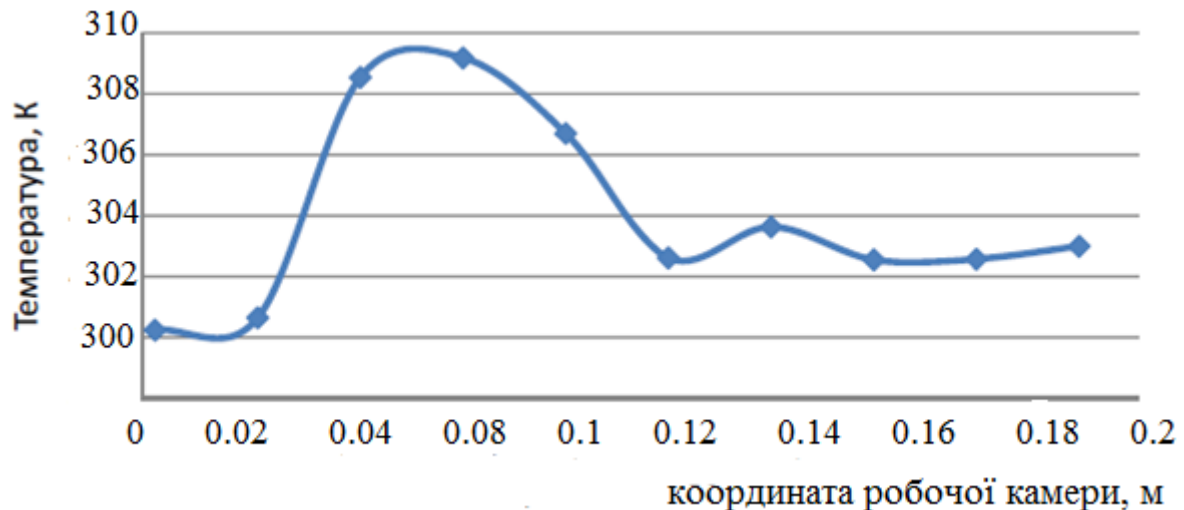
Рис. 4.6. Графік розподілу температури по довжині робочої камери змішувача
