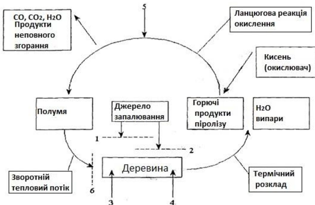
Рисунок 1.1 - Схема процесу горіння деревини і заходи, спрямовані на його придушення 1 - покриття що мають здатність спучуватися; 2 - вогнезахисні обмазки, фольга; 3 - мінеральні наповнювачі; 4 - антипірени; 5 - інгібітори полум'яного горіння; 6 - обвуглювання
