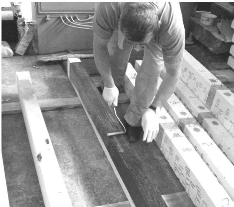
Рисунок 2.6 Підсилення дослідного зразка полотном Sika Wrap
