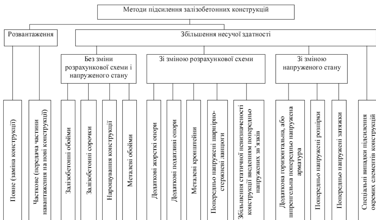
Рисунок 1.2 Класифікація методів підсилення залізобетонних конструкцій
