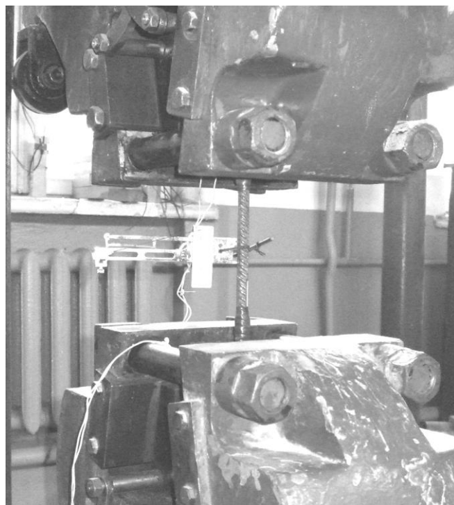
Рисунок 2.2 Випробування арматурних зразків
