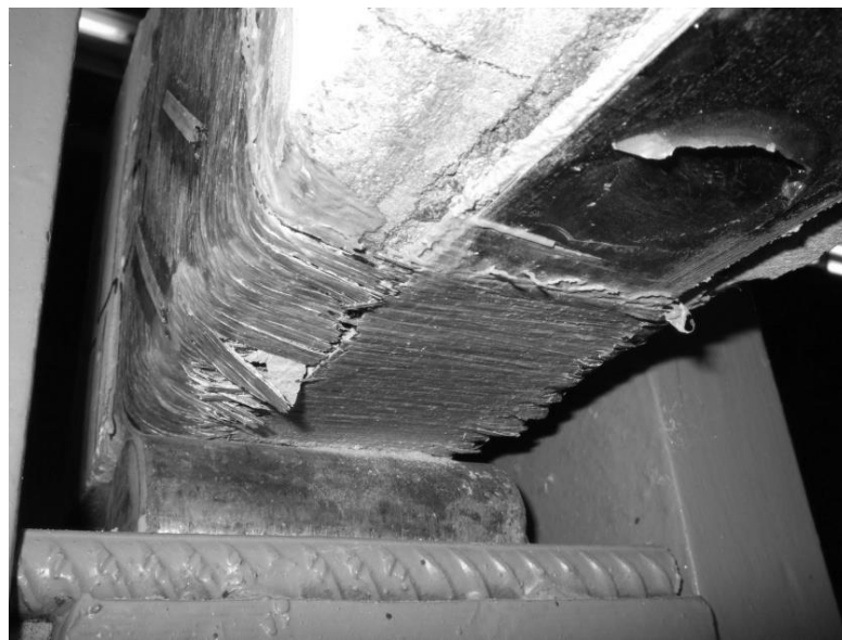
Рисунок 3.1 Руйнування волокон системи анкерування
