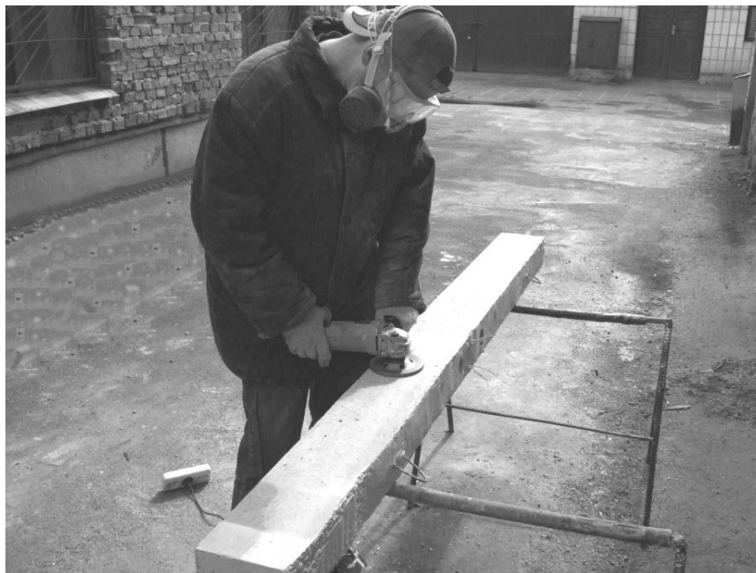
Рисунок 2.5 Підготовка дослідних зразків до підсилення
