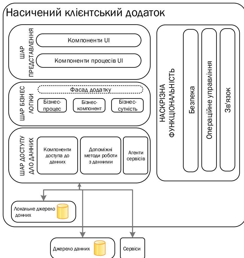
Рисунку 1.4 – Загальне уявлення архітектури типового насиченого клієнтського додатка
