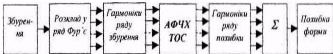
Рисунок 2.4 - Схема алгоритму визначення похибки формоутворення
