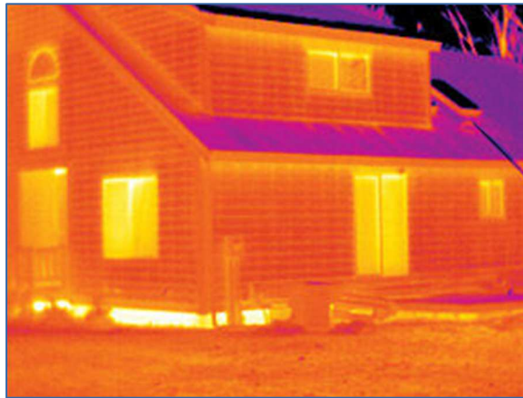
Рисунок 5.2 – Знімок тепловізором будинку з великими втратами тепла
