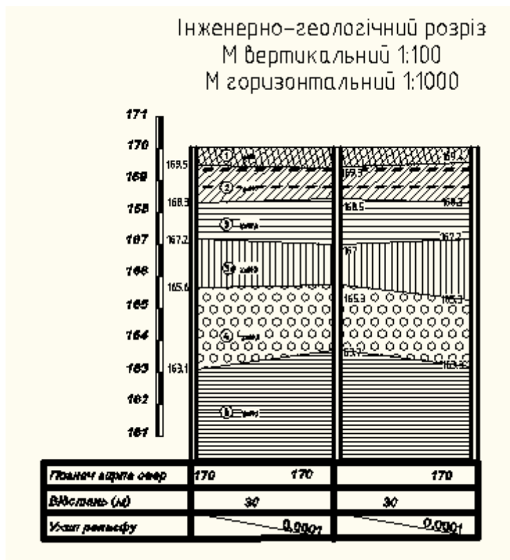
Рис 2.1 Геологічний розріз будівельного майданчика
