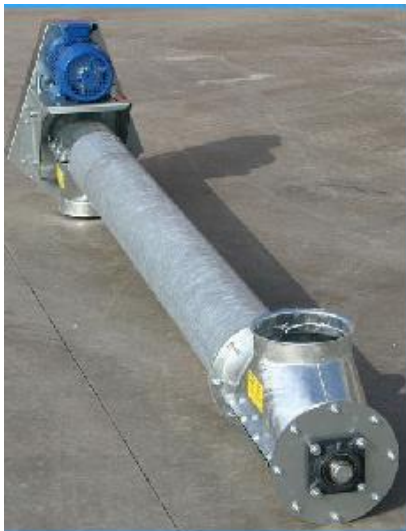
Рисунок 1.7 – Конструктивна схема (а) та загальний вигляд (б, в, г) горизонтального шнекового транспортера: 1 – кожух; 2 – шнек; 3 – опора; 4 – завантажувальна та розвантажувальна горловина; 5 – фланець; 6 – редуктор; 7 – електродвигун.
