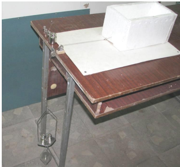
Рис. 3.3 - Загальний вигляд лабораторної установки для визначення коефіцієнта тертя спокою бульб
