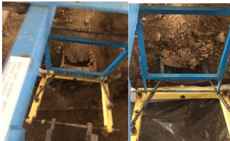
Рис.3.8. Фото підкопувально-сепарувального робочого органа з рулоном плівки
