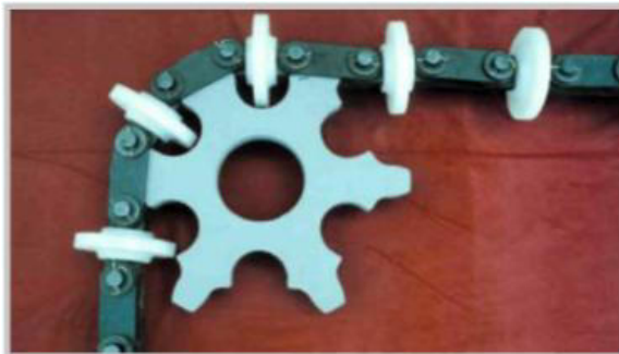
Рис. 1.12. Загальний вигляд робочого органу конвеєра фірми “Spiroflow Limited” а– загальний вигляд; б – робочий орган з привідною зірочкою; в – з матеріалом в процесі його транспортування
