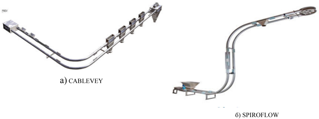
Рис. 5.1 Конструкції трубчастих скребкових конвеєрів закордонних фірм Траси конвеєрів можуть бути розміщені в одній площині або у просторі.
