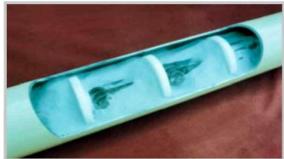
Рис. 1.12. Загальний вигляд робочого органу конвеєра фірми “Spiroflow Limited” а– загальний вигляд; б – робочий орган з привідною зірочкою; в – з матеріалом в процесі його транспортування
