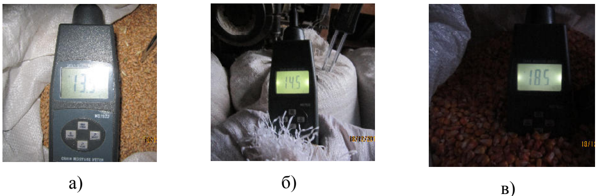
Рис. 4.1. Процес виміру вологості вологоміром марки Grain Moisture Meter MD7822 для сипких матеріалів: а)- пшениця; б)- горох
