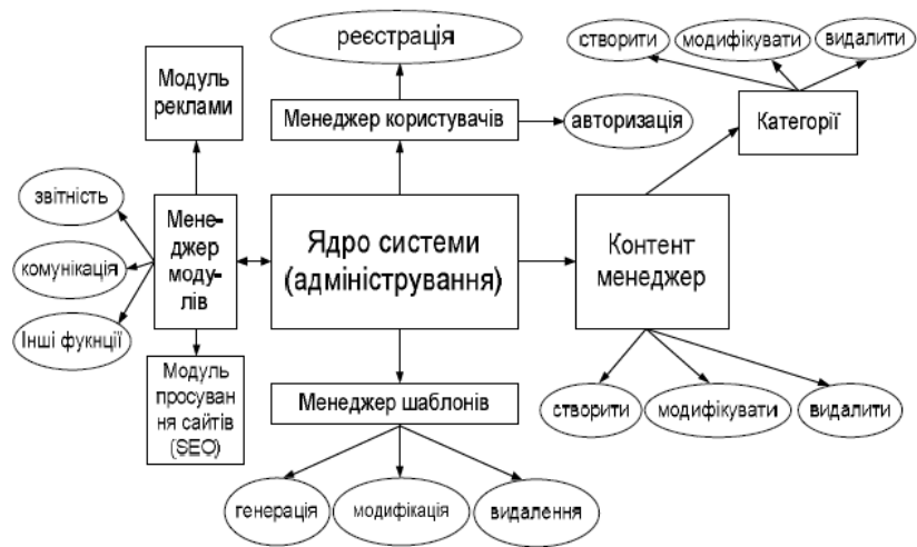
Рисунок 2.3 – Архітектура спеціалізованої програмної системи на прикладному рівні
