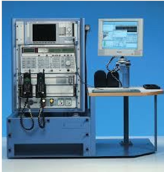
Рисунок 1.11. Зовнішній вигляд системи Rohde&Schwarz TS995X
