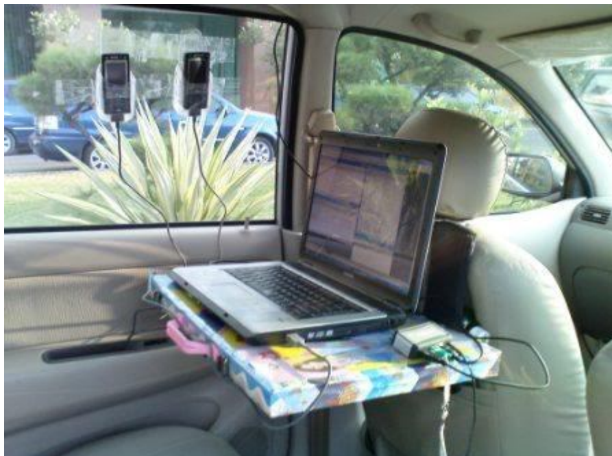
Рисунок 1.12. Обладнання TEMS Investigation, встановлене всередині автомобіля
