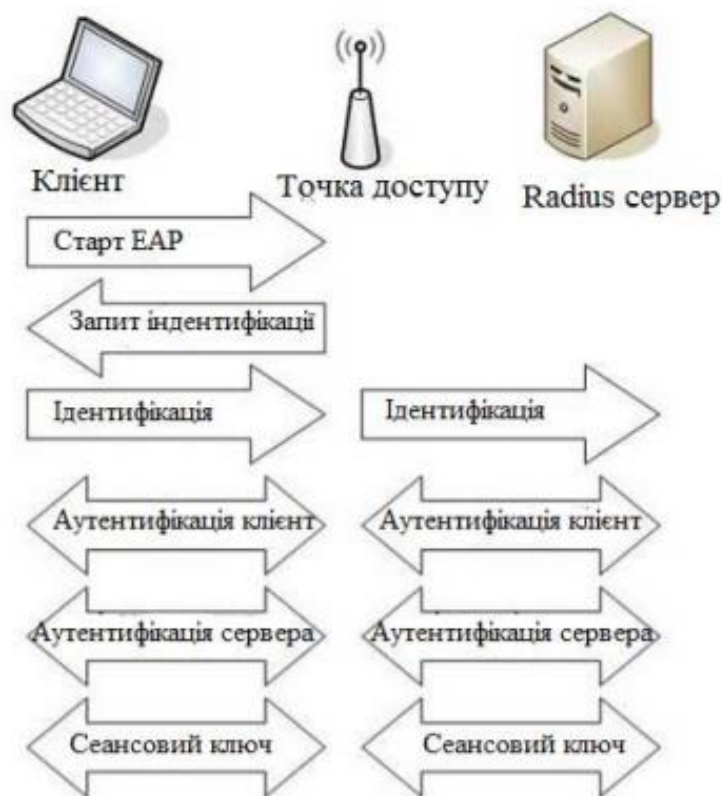
Рисунок 2.6 – Процес аутентифікації за алгоритмом EAP
