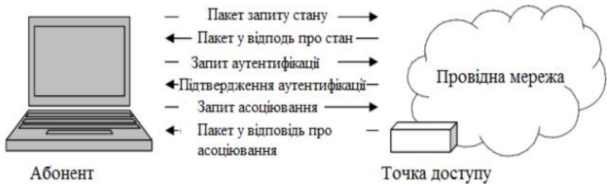
Рисунок 2.1 – Процес аутентифікації абонента в безпроводну мережу
