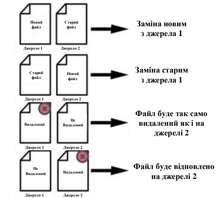
Рисунок 1.4 - Схема реплікації даних
