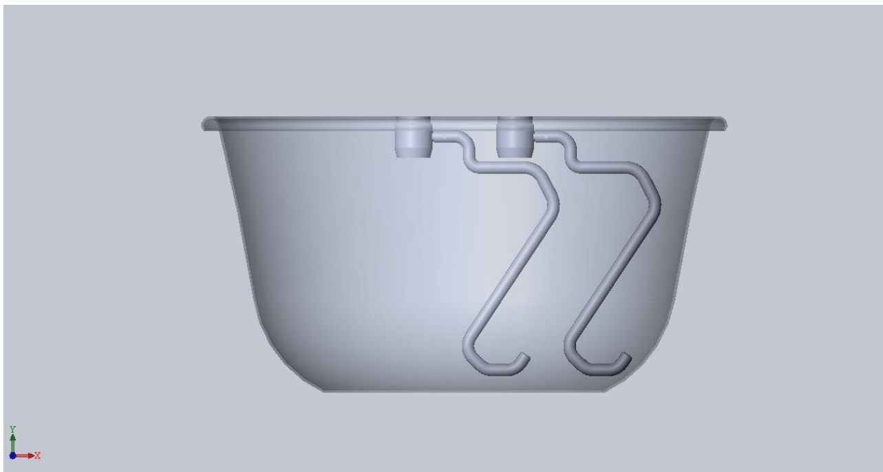
Рис. 4.1. Схема взаємного розміщення лопатей тістомісильної машини Г4-МТМ-330-01
