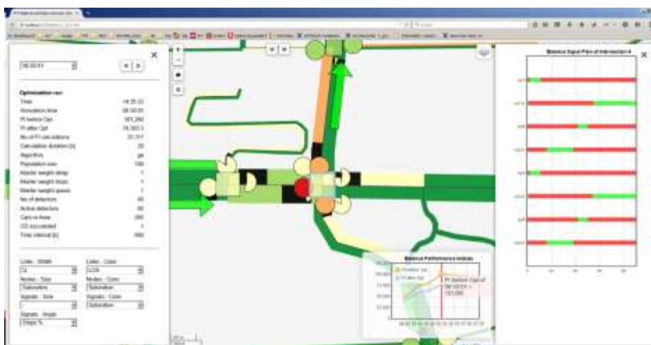
Рисунок 4.5 – Адаптивне регулювання: Balance
