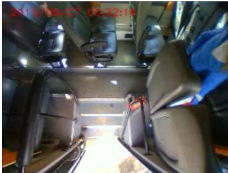
Рисунок 3.4 – Вид з камери обліку пасажирів на задніх дверях автобуса
