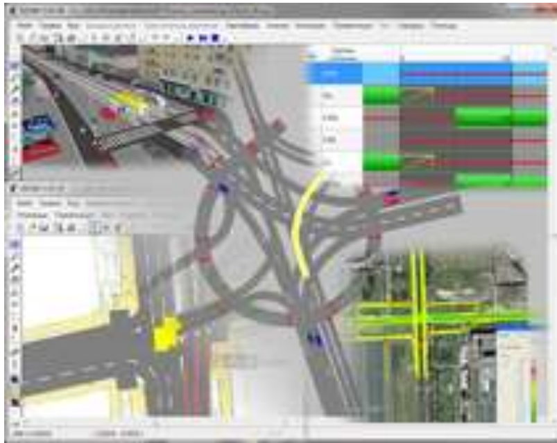
Рисунок 4.1 – Імітаційне моделювання транспортного руху (вікно програми VISSIM)
