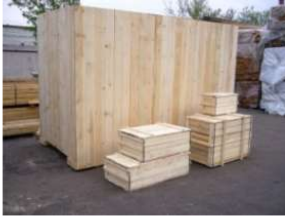
Рис. 3.4. Упакування окремих модулів промислового обладнання (габарити: довжина – 1680 мм; ширина – 1240 мм; висота – 1240 мм, вага – 2,5...5 тонн)
