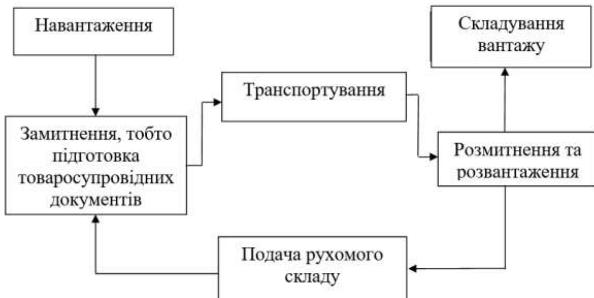
Рис. 3.1. Технологічна схема перевезення вантажів ТОВ «Поділля-Транс»
