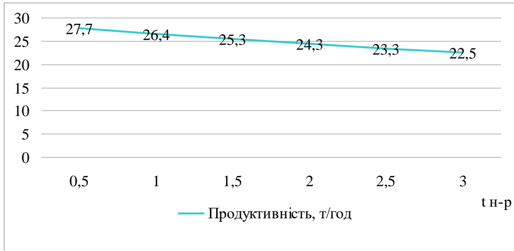
Рисунок 4.6 – Графік залежності продуктивності автомобіля від часу простою під навантажувально-розвантажувальними роботами
