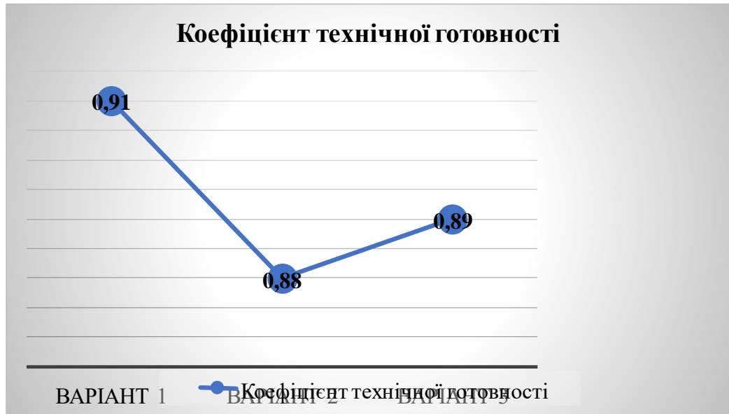
Рисунок 3.2.1 – Залежність коефіцієнту технічної готовності автопарку від обсягу перевезень
