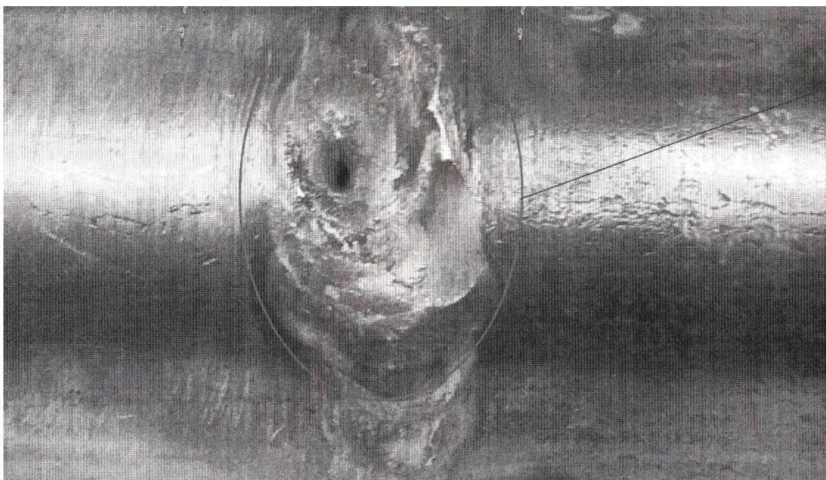
а) свищ, нерівномірна ширина шва
