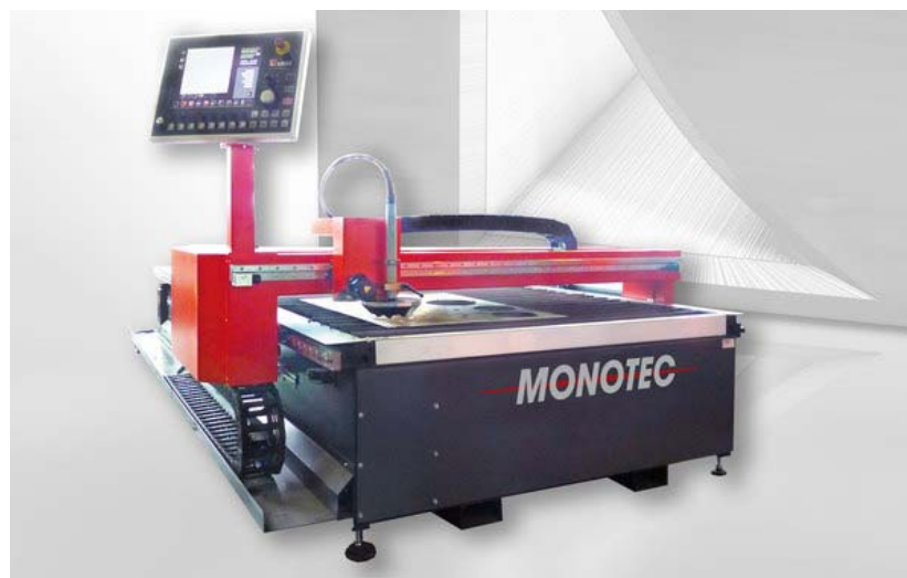
Рис. 3.2 – Загальний вигляд порталної автоматичної машини MONOTEC Type-1530
