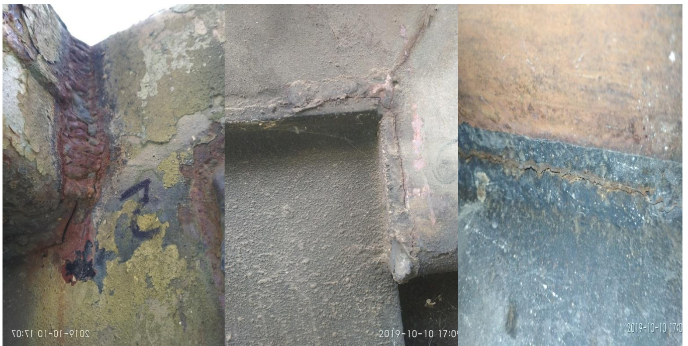
Рисунок 2.3- Загальний вигляд дефектів рами ескаватора
