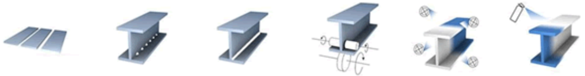
Рисунок 1.3. Виготовлення балок методом зварювання.
