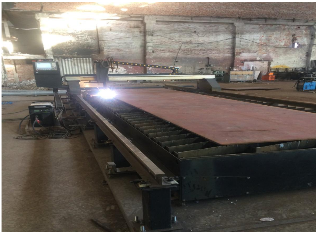
Рисунок 3.4. Загальний вигляд плазмового різакa Hypertherm Powermax 105 та установки з ЧПУ MASTER CUT.
