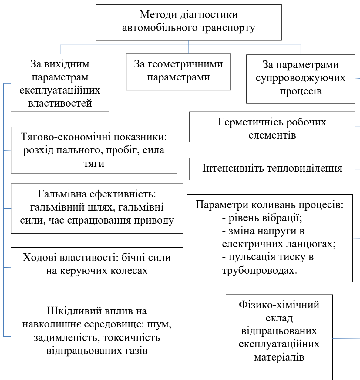
Рисунок 5.1- Класифікація методів діагностики автомобільного транспорту
