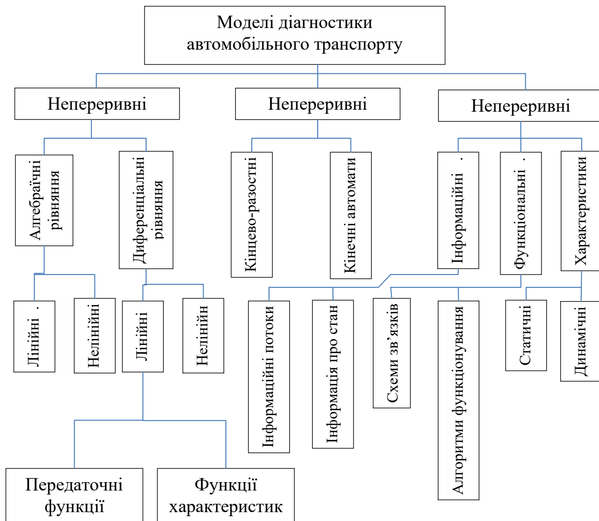
Рисунок 5.2- Класифікація моделей діагностики автомобільного транспорту
