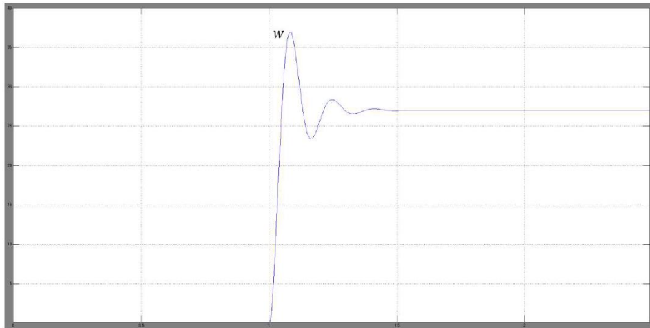
Рисунок 3.10. Привід кута місця перехідний процес в контурі регулювання швидкості
