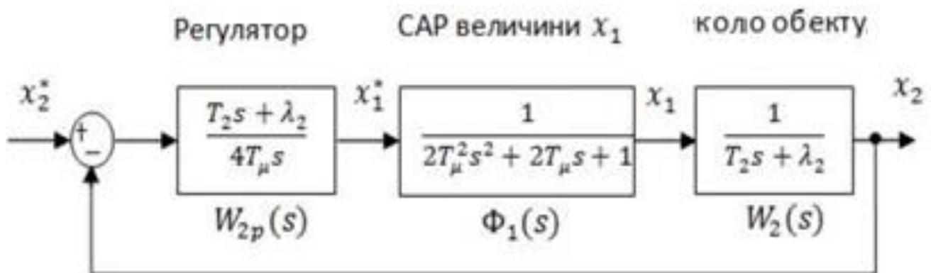
Рисунок 2.2. Схема для розрахунку системи регулювання величини x_2
