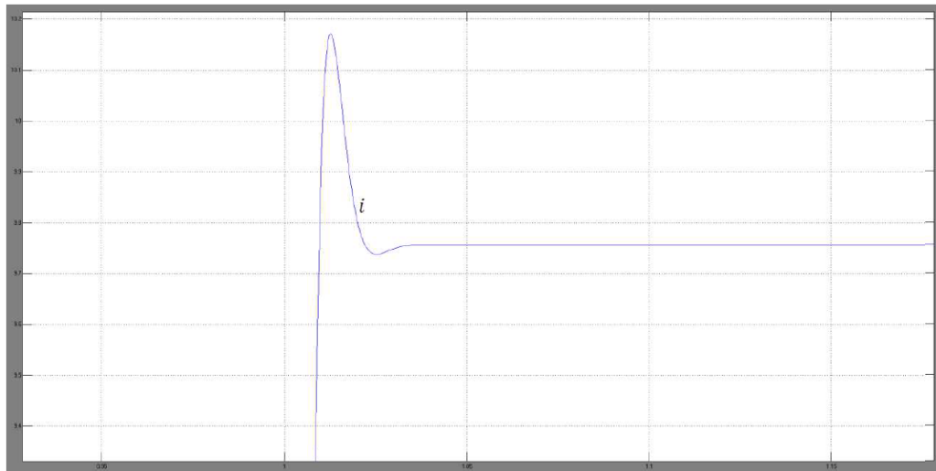
Рисунок 3.5. Привід поперечного крену перехідний процес в контурі регулювання струму
