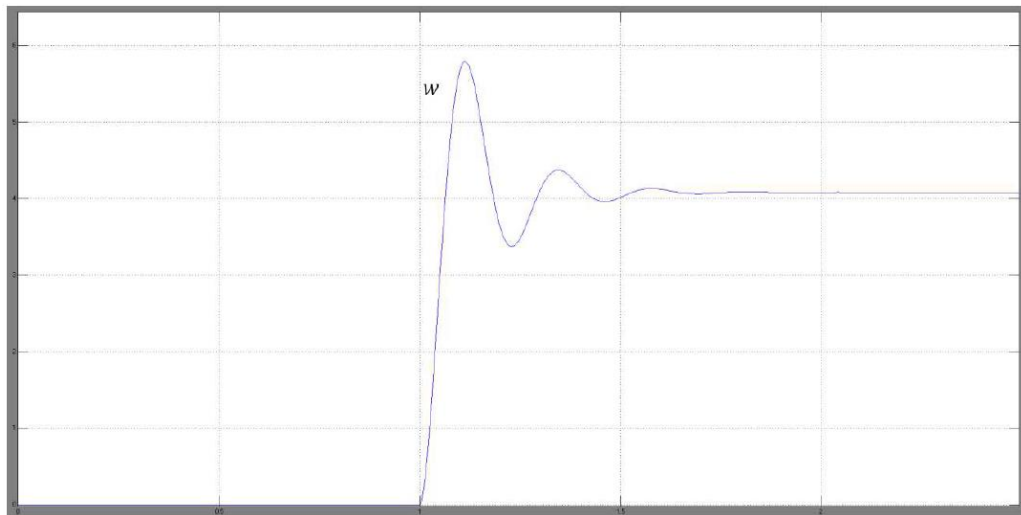
Рисунок 3.14. Привід азимуту перехідний процес в контурі регулювання швидкості
