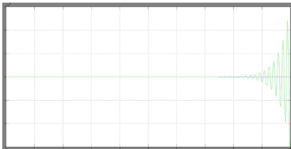
Рисунок 3.19. Привід поперечного крену перехідний процес в контурі регулювання положення
