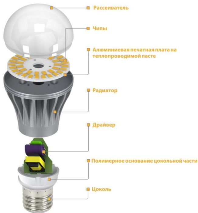
Рисунок 1.12 – Конструктивне виконання та будова LED-лампи
