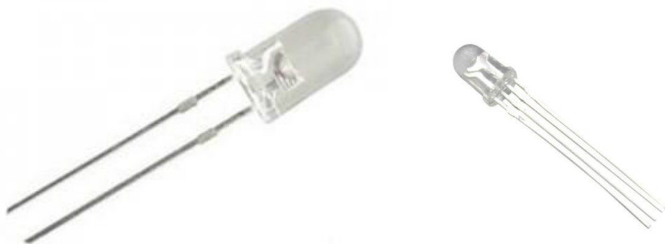
Рисунок 1.6 – Загальний вигляд DIP та SLED
