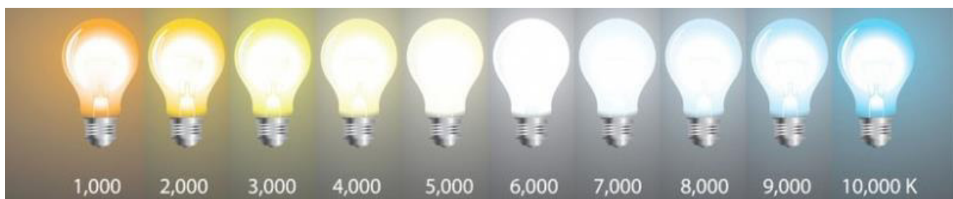
Рисунок 1.3 – Колірна температура LED-ламп
