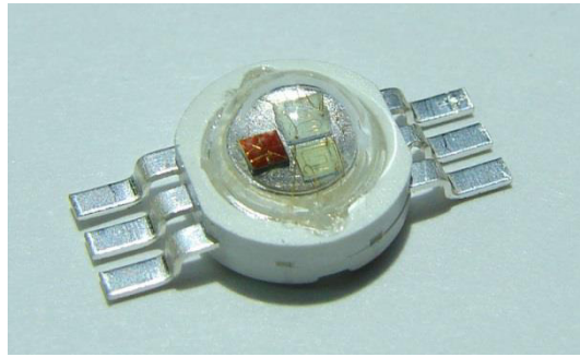
Рисунок 1.9 – Загальний вигляд потужного, ультрафіолетового RGB LED
