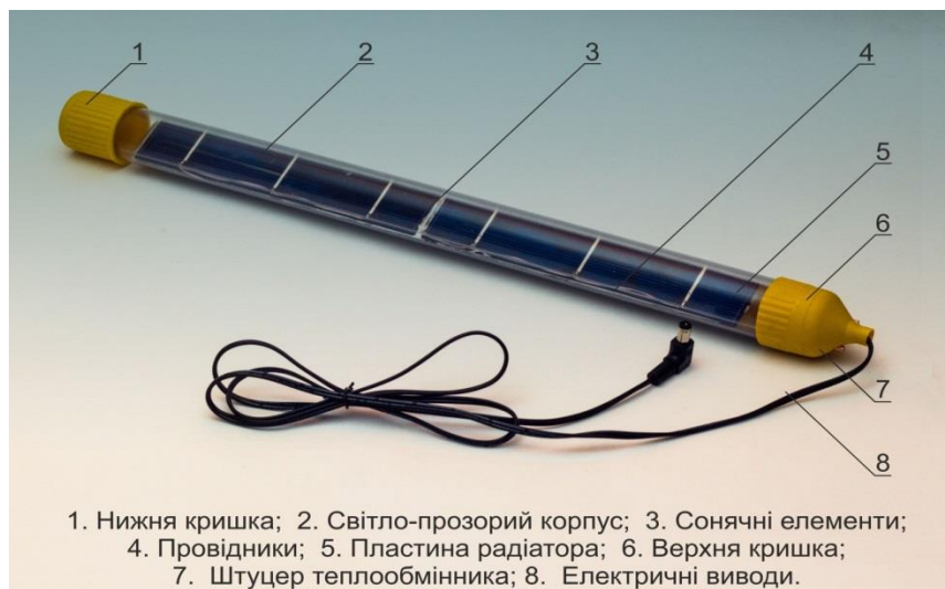
Рис. 3. Вдосконалена фізична модель PV/T колектора трубчастої форми
