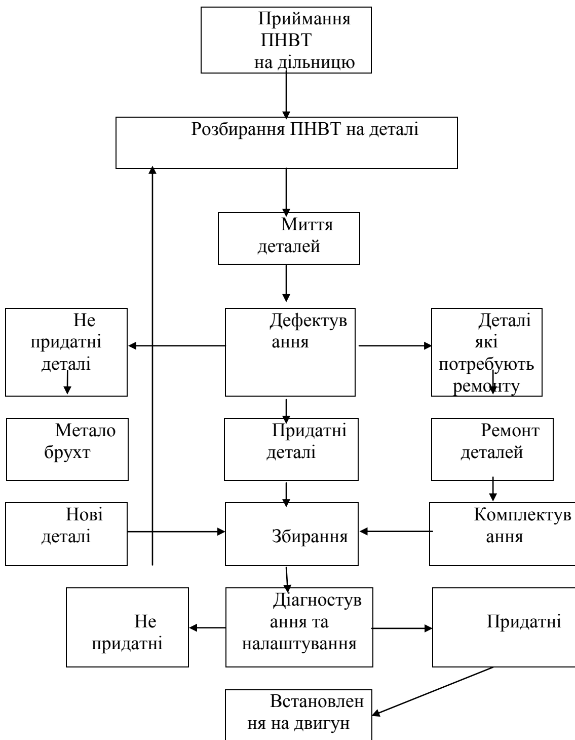
Рисунок 2.1 - Схема технологічного процесу ПР ПНВТ
