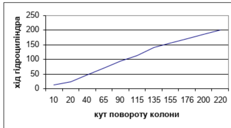
Рисунок 2.4 – Залежність ходу гідроциліндра від кута повороту колони
