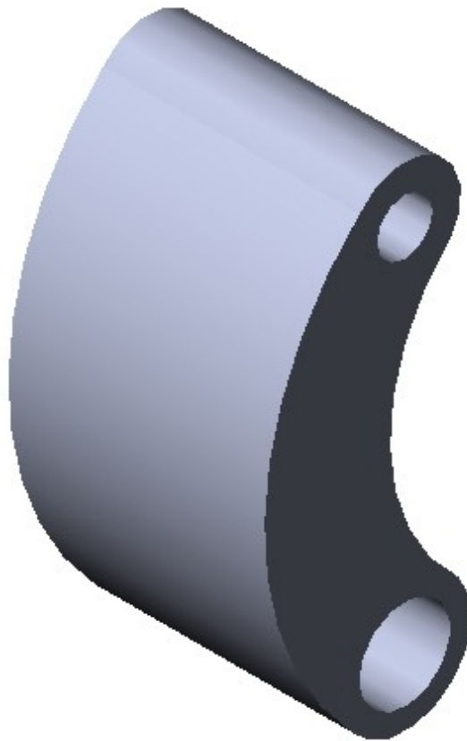
Рисунок 4.1 – Твердотільна модель коромисла рухомої опори
