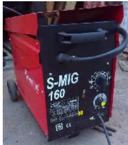
Рисунок 5.3 - Зовнішній вигляд зварювального трансформатора типу S - MIG-160
