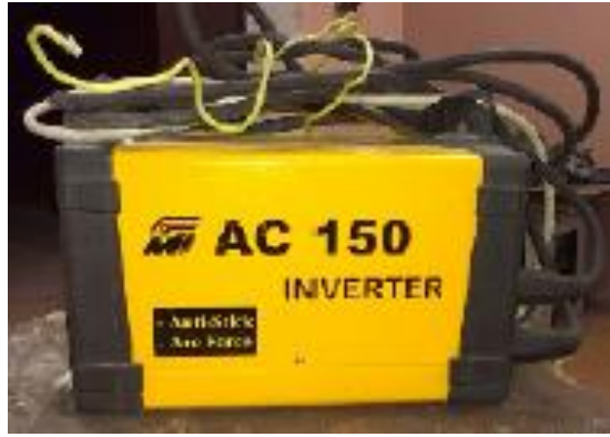
Рисунок 5.5 - Зовнішній вигляд зварювального інверторного трансформатора типу AC 150 INVERTER
