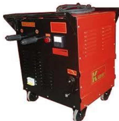
Рисунок 5.7 - Зовнішній вигляд зварювального трансформатора типу ВД-301УЗ
