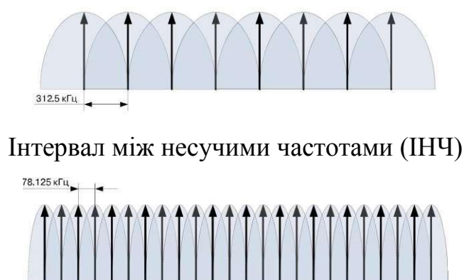
Рис. 2.2. Зміна ІНЧ OFDM модульованого сигналу в стандарті 802.11ax
