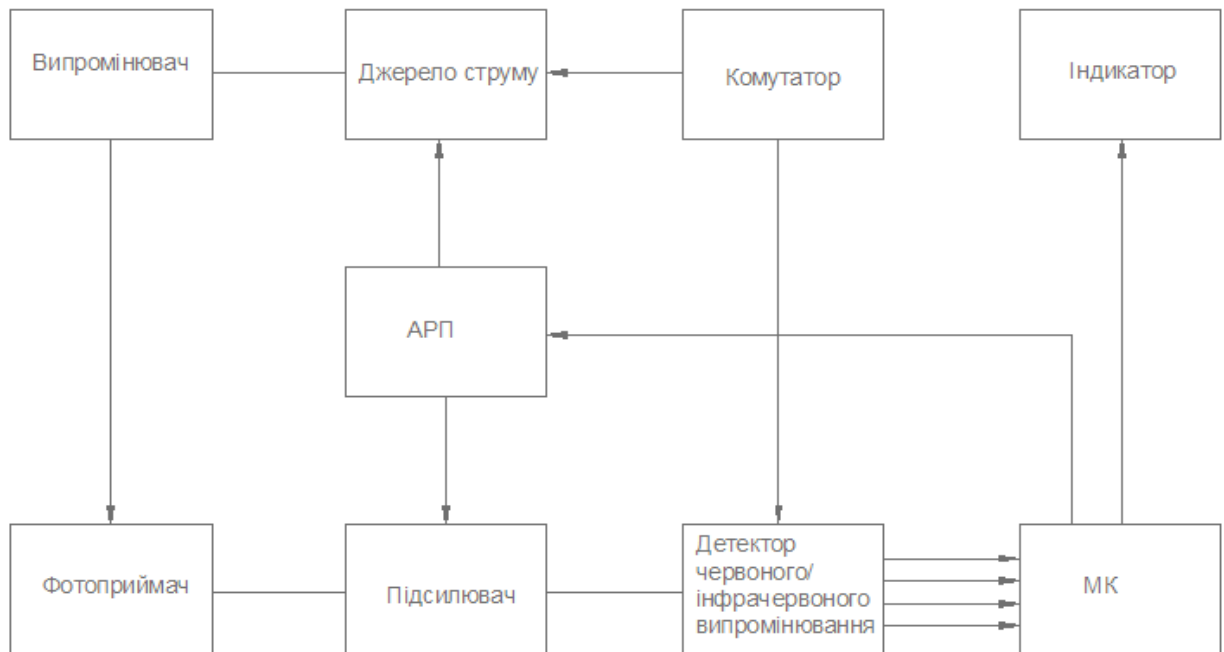
Рис. 3.4 Структурна схема пульсоксиметра
