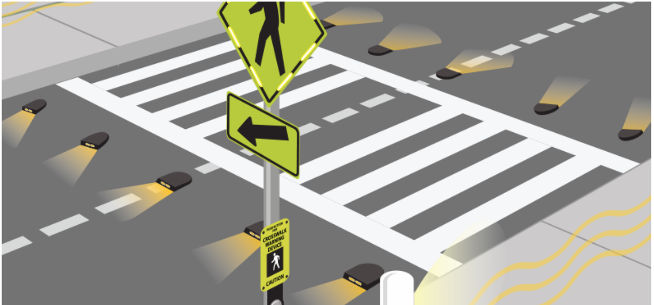
Рис. 1.6. Розміщення освітлювальних елементів
