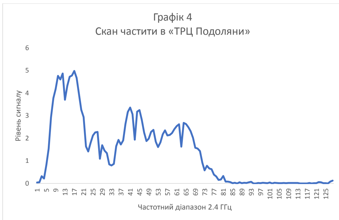
Рис. 3.22. Скан частотного вузькосмугового діапазону 2,4ГГц в «ТРЦ Подоляни»
