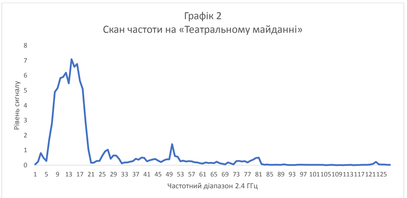
Рис. Д.2. Скан частотного діапазону 2.4 ГГц на «Театральному майданні»
