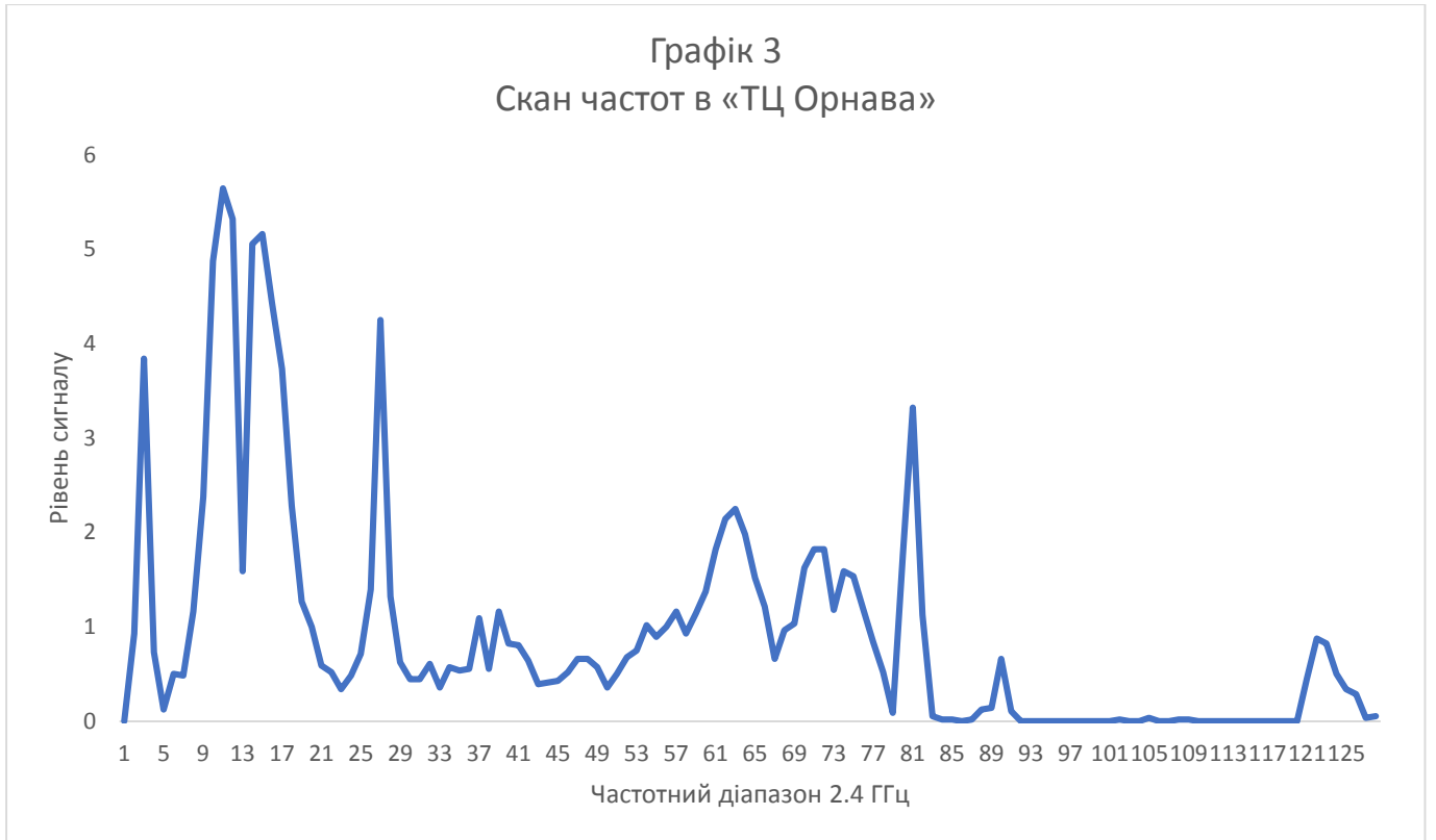
Рис. Д.3. Скан частотного діапазону 2.4 ГГц в «ТЦ Орнава»
